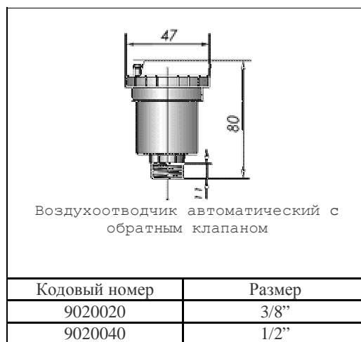
Рис. 4. Габаритные и присоединительные размеры воздухоотводчика автоматического типа EAGLE
