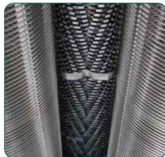
Фильтрующие барабаны из спиральных прутьев
